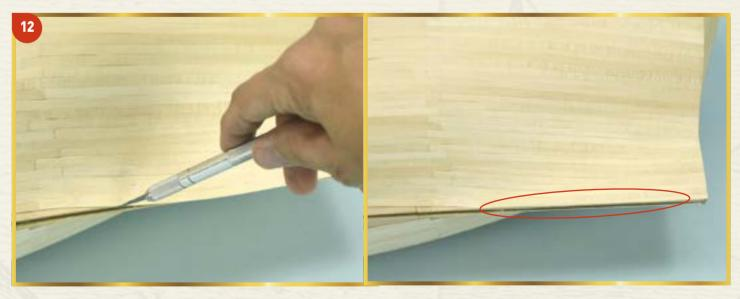
**12** Возможно, планка, приклеенная к кормовой части в предыдущем шаге, будет выступать за край килевой рамки. В этом случае с помощью острого ножа выровняйте ее по краю рамки.
