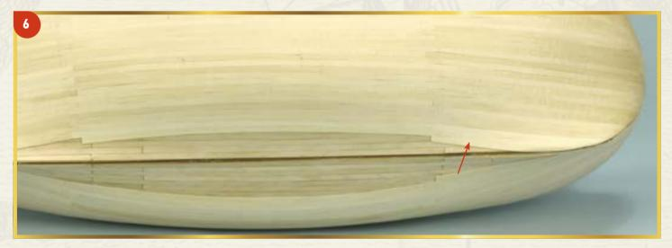
Начните укладывать новый пояс обшивки, приклеив оставшийся от предыдущих работ фрагмент планки к носовой части корпуса.
