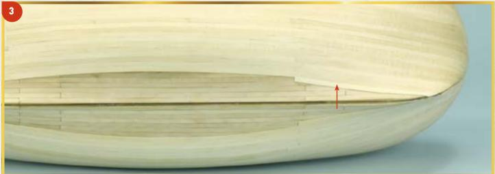
3 Начните новый (под предыдущим) пояс обшивки, приклеив фрагмент планки к носовой части корпуса.
