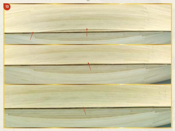
13 Теперь вам осталось обшить совсем небольшую часть корпуса. Приклейте на левом борту несколько планок, чтобы завершить чистовую обшивку. Последнюю планку обрежьте таким образом, чтобы она была вровень с краем килевой рамки.
