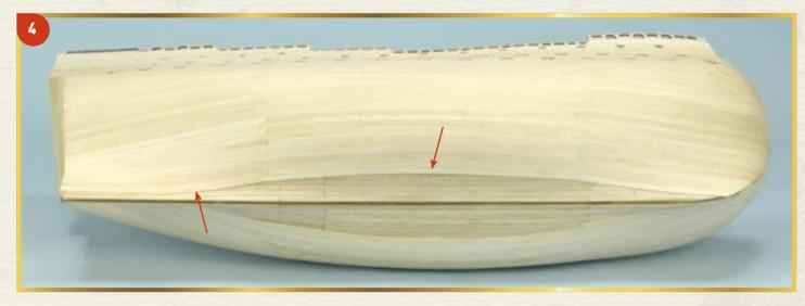
**4** Завершите текущий пояс обшивки, приклеив две планки: одну — к центральной, а другую — к кормовой части корпуса.
