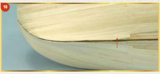
10 Начните укладывать новый пояс обшивки, приклеив должным образом обрезанный фрагмент планки к носовой части корпуса.
