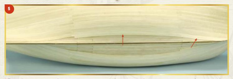
Приклейте планку к носовой части корпуса — под поясом обшивки, который вы только что установили. Затем приклейте рядом с ней, к центральной части корпуса, вторую планку.
