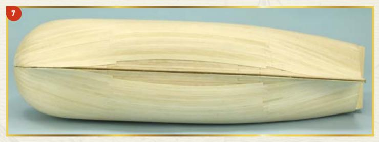
Теперь перейдем к работе на левом борту модели: в симметричном порядке выполните на нем те же операции, что и на правом борту, сделав чистовую обшивку одинаковой на обеих сторонах корпуса.
