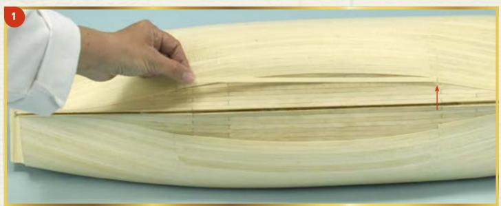
1 В данном выпуске мы наконец-то закончим монтаж чистовой обшивки модели с помощью планок 0,5 х 5 х 300 мм, оставшихся от работ на предыдущих этапах. Начнем с правого борта корпуса: подготовьте новую планку и приклейте ее рядом с последней планкой, установленной на этапе 75.
